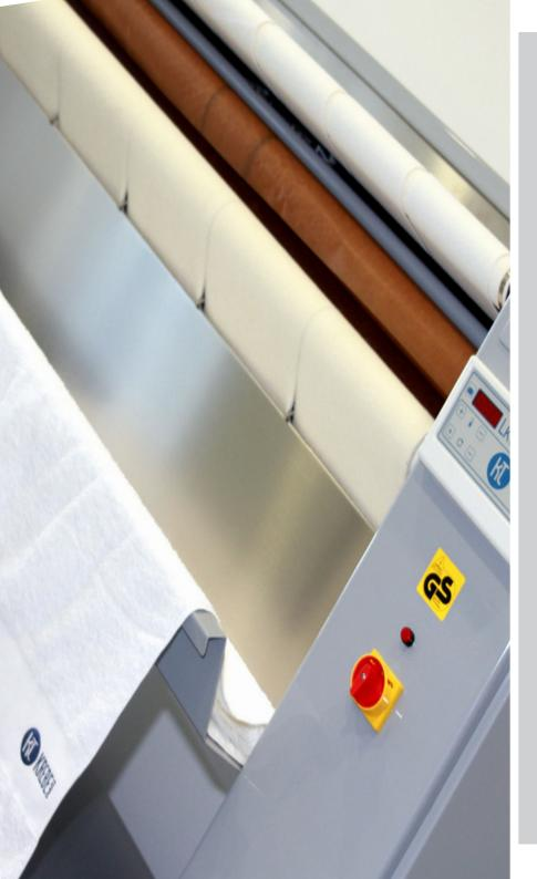
Гладильно-сушильная машина LSK 70, ленточная машина с регулируемой температурой и скоростью глажения в зависимости от типа белья. Подходит для больших прачечных, гостиниц, больниц, домов престарелых, гостиничные комплексы. Она отличается отличным качеством глажения, низкими эксплуатационными расходами и длительным сроком службы.
